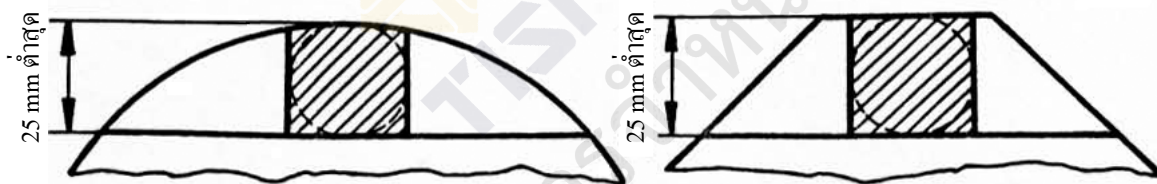
รูปที่ จ.7 ขั้วทดสอบที่มีภาคตัดรูปกลมหรือหกเหลี่ยม (ข้อ จ.4.2.2 และข้อ จ.4.2.3)
