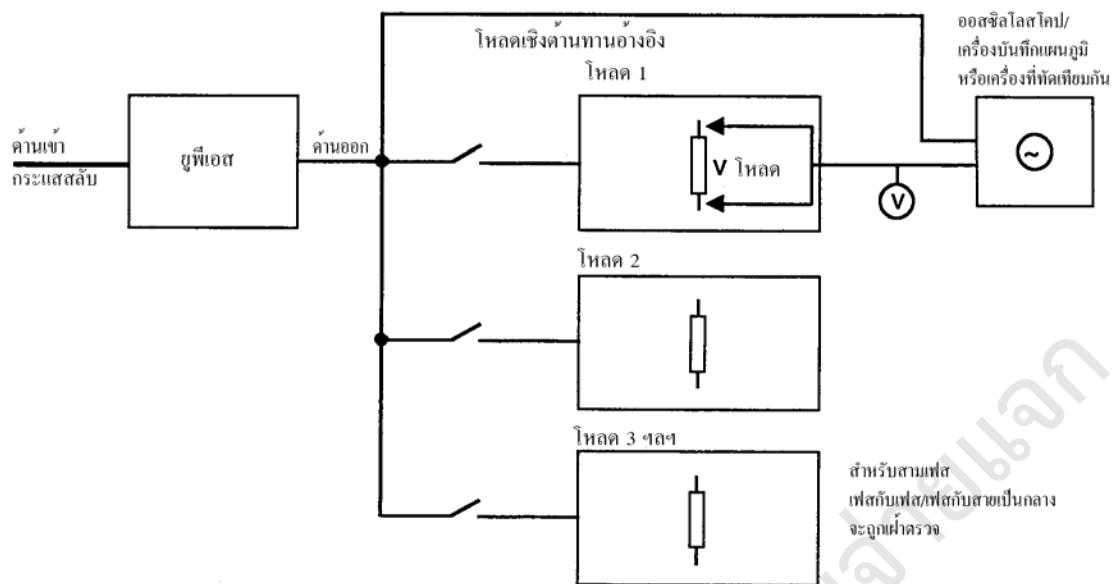
รูปที่ ช.1 วิธีทดสอบโหลดเชิงต้านทาน – การเปลี่ยนแบบวิธีการทำงาน/โหลดเป็นขั้น
