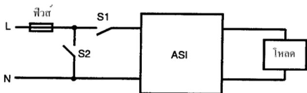
รูปที่ ช.1 การต่อของวงจรทดสอบ
